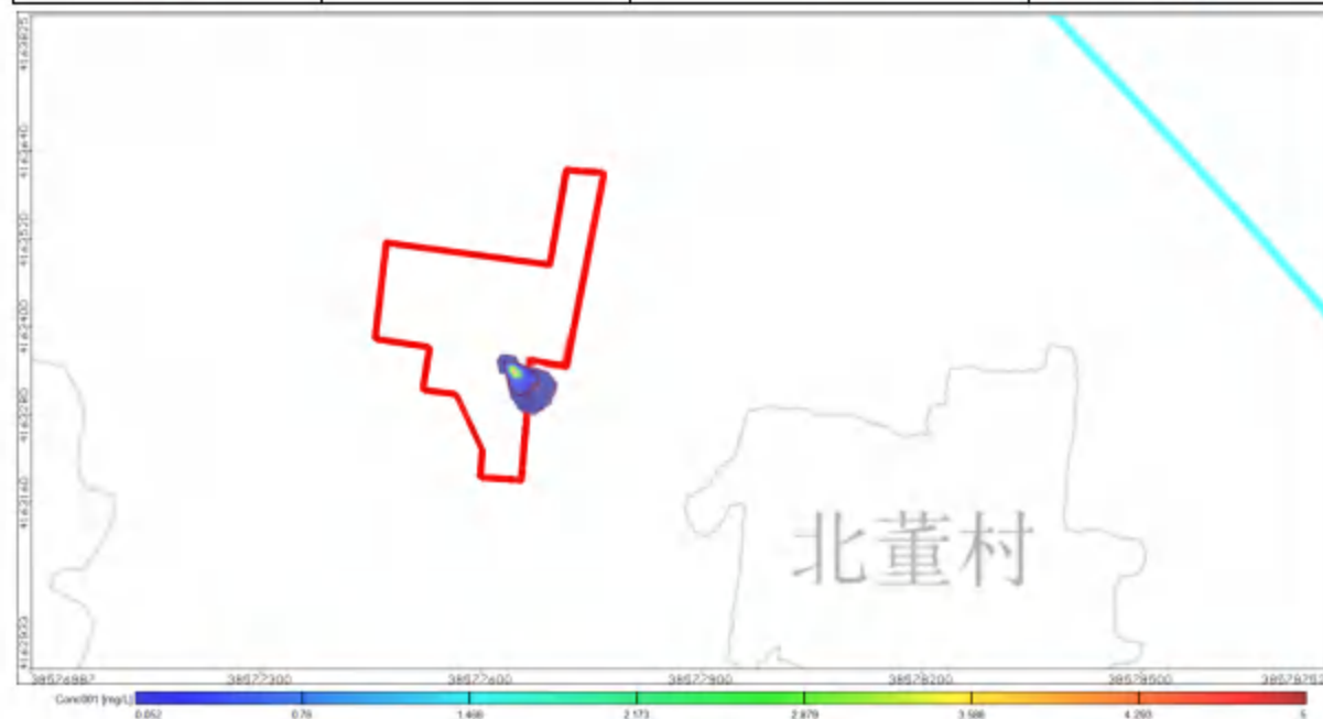
图 5.2-15 隔油调节池泄漏情景下氨氮对地下水环境影响范围图-100d
